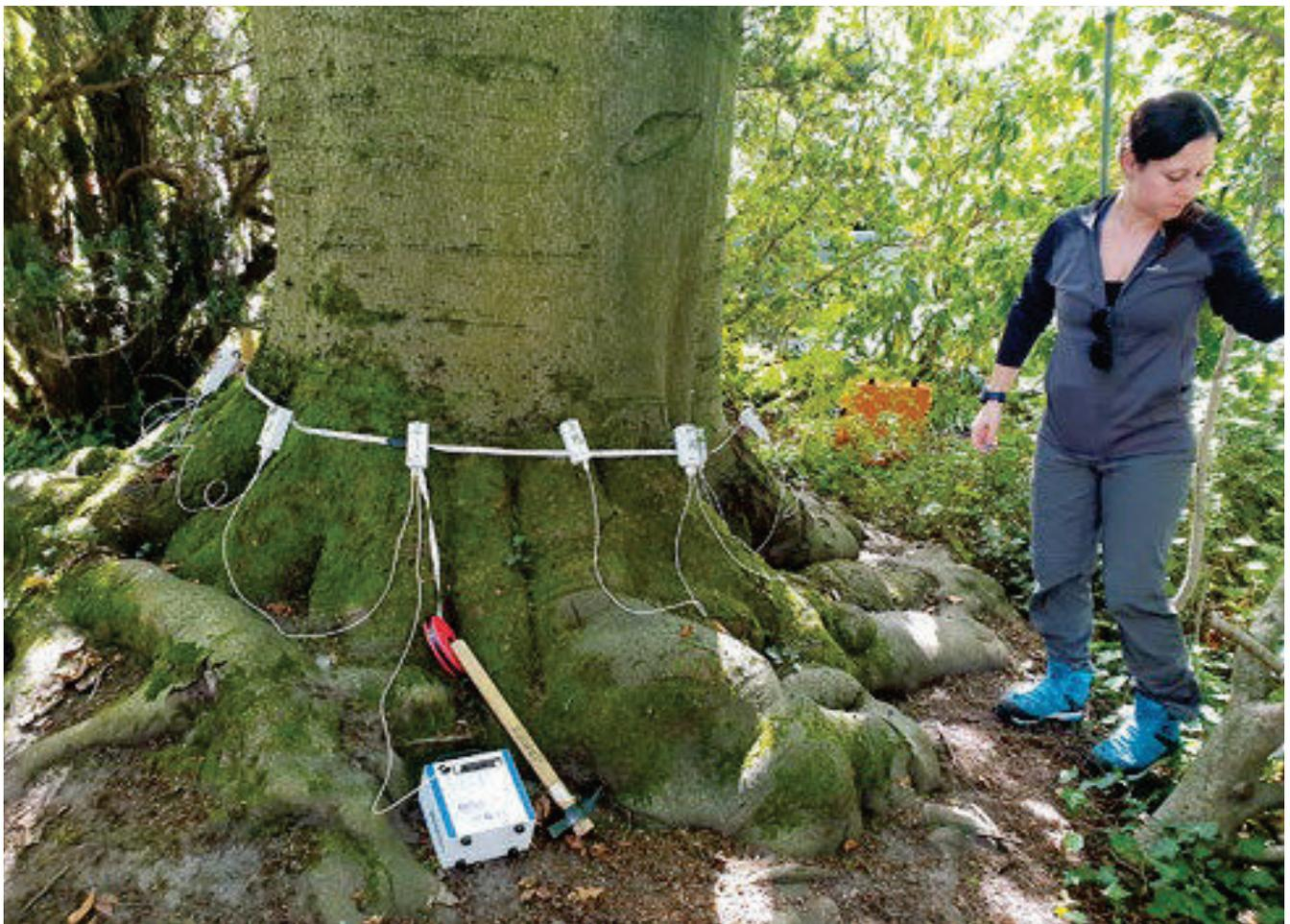
ein Schallimpuls erzeugt und über Messstifte, die durch die Rinde auf den äußeren Jahresring gebracht werden, in den Holzkörper eingekoppelt. Da bei jedem Klopfen alle Sensoren die Laufzeit erfassen, entsteht ein dichtes Netz von Schallgeschwindigkeitsdaten.
